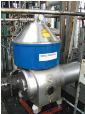
Centrifuga modello MACFUGE 105 BD M 3 S installata in un impianto per la produzione di biodiesel nella fase di separazione della glicerina.
