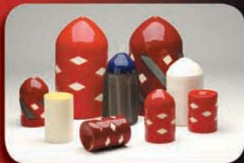
吉洛德泡沫清管器，有开放式聚氨酯泡沫。适用于轻度、中度及重度积垢。可以针对不同特点的管道进行清洗，如三通、弯头及多变径，这是其他清管器无法完成的。
